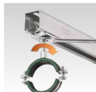
Do MPR-rychloupínacího čepu zašroubujte závitový čep a zajistěte šestihrannou kontramaticí. Poté namontujte objímku.
